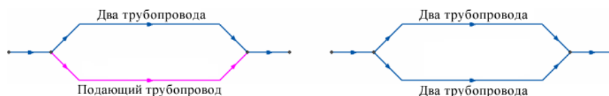
Рисунок 3.7. Изображение трехтрубной и четырехтрубной сети
