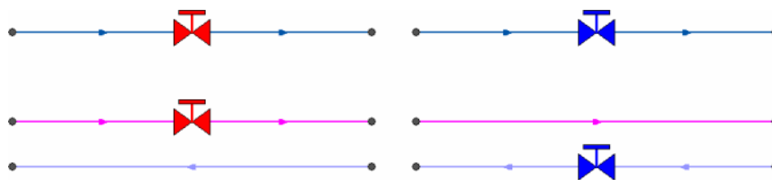
Рисунок 3.37. Сверху: однолинейное изображение сети, снизу – внутреннее представление
