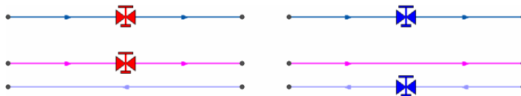
Рисунок 3.36. Сверху: однолинейное изображение сети, снизу – внутреннее представление
